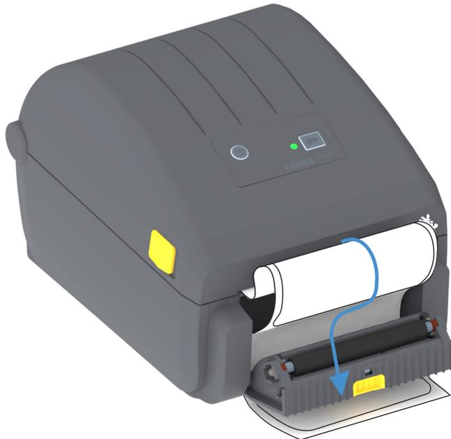
4. Feche a porta do distribuidor enquanto puxa firmemente a extremidade do revestimento da etiqueta.
