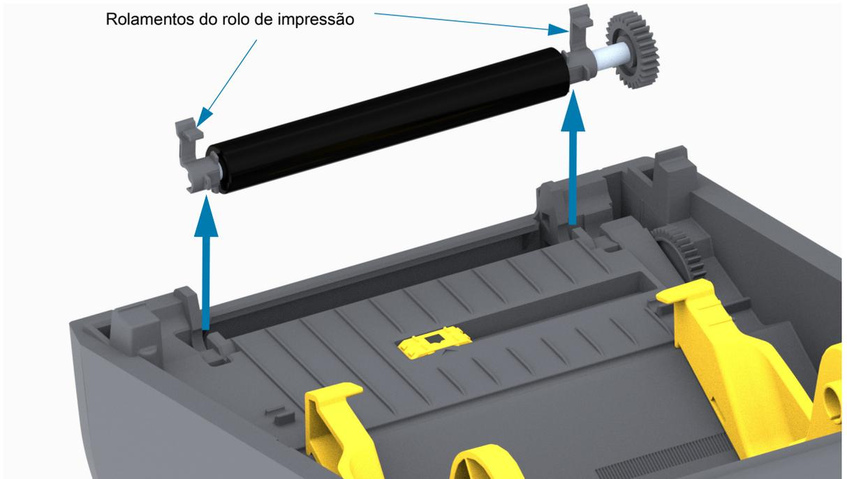
4. Deslize a engrenagem e os dois (2) mancais para fora do eixo do rolo de impressão.
