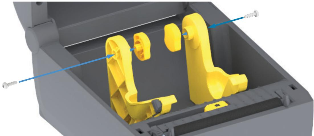
2. Coloque o adaptador dentro do suporte de rolo. O lado maior do adaptador está na parte superior. O lado liso (sem nervuras) está voltado para o meio da impressora.
