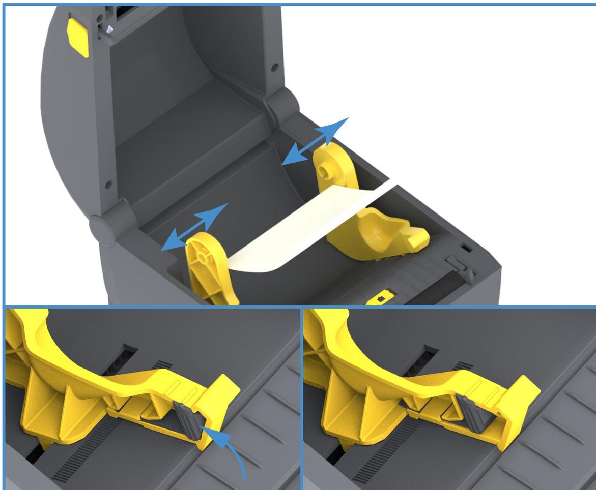
3. Insira a mídia pela fenda na parte de trás da impressora e coloque a mídia entre a guia de mídia e os suportes de rolo.
