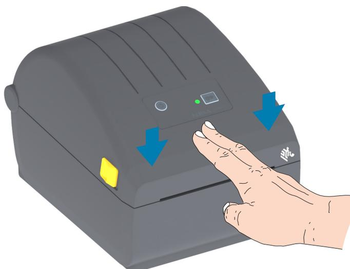
Pode ser necessário calibrar sua impressora para a mídia. Os sensores da impressora precisam de ajuste para detectar a etiqueta, o revestimento e a distância entre as etiquetas para operar adequadamente. Ao recarregar a mesma mídia (tamanho, fornecedor e lote), você pode apenas pressionar o botão AVANÇAR uma vez para preparar a mídia para a impressão.
