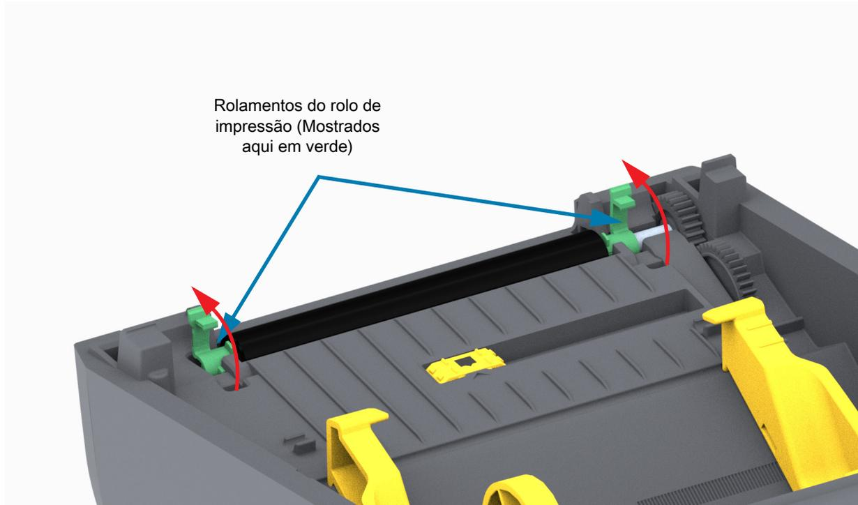
3. Levante o rolo de impressão para fora da estrutura inferior da impressora.
